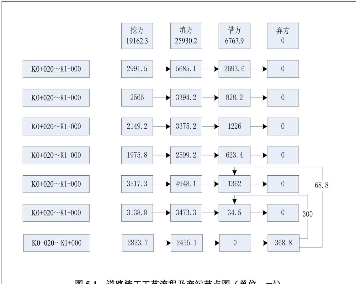
图 5-1 道路施工工艺流程及产污节点图 (单位: m<sup>3</sup>)
