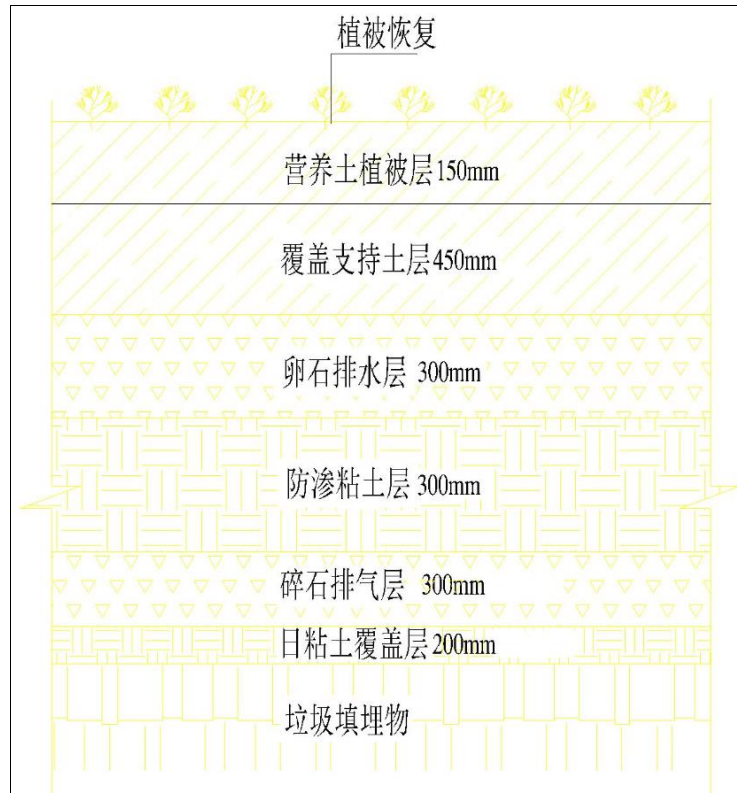
图 5.2-2 封场工程覆盖系统构造图
