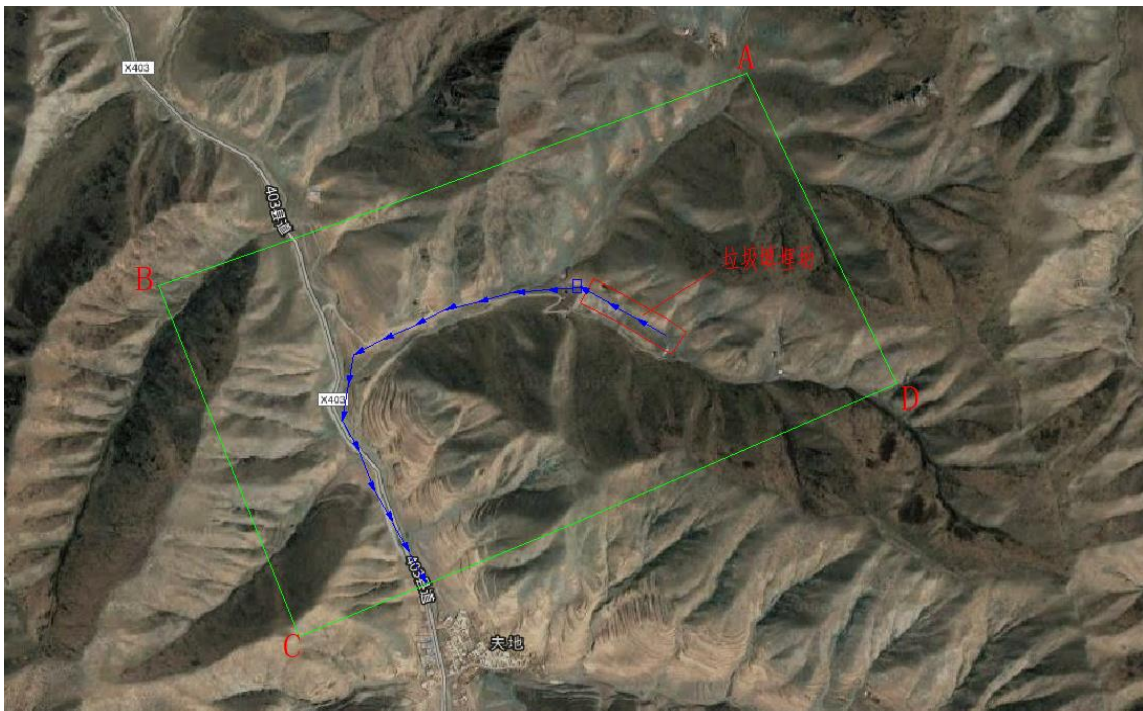
图 4.3-14 从污染源出发的示踪粒子迁移迹线图（迹线中每箭头长度代表 1000d 迁移距离）
