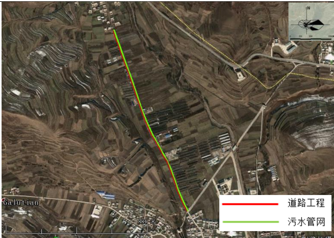
图2 污水管网布设图
