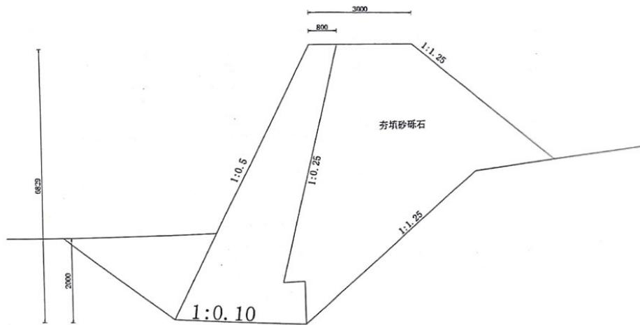
图 2.2-8 仰斜式挡土墙堤防
