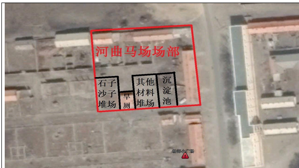
图 7 项目施工平面布置图
