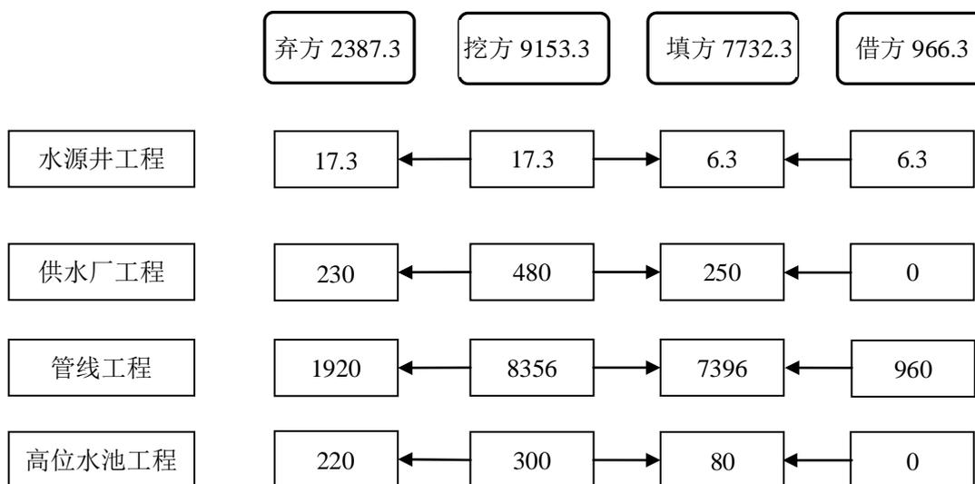
图 2 土石方平衡流向图 单位：m<sup>3</sup>
