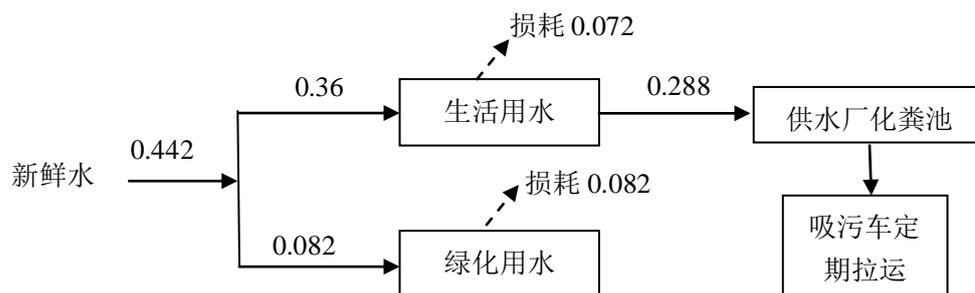
图 1 项目用水平衡图 单位： $\text{m}^3/\text{d}$
