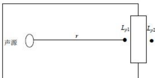
图 6 室内声源等效为室外声源图例
