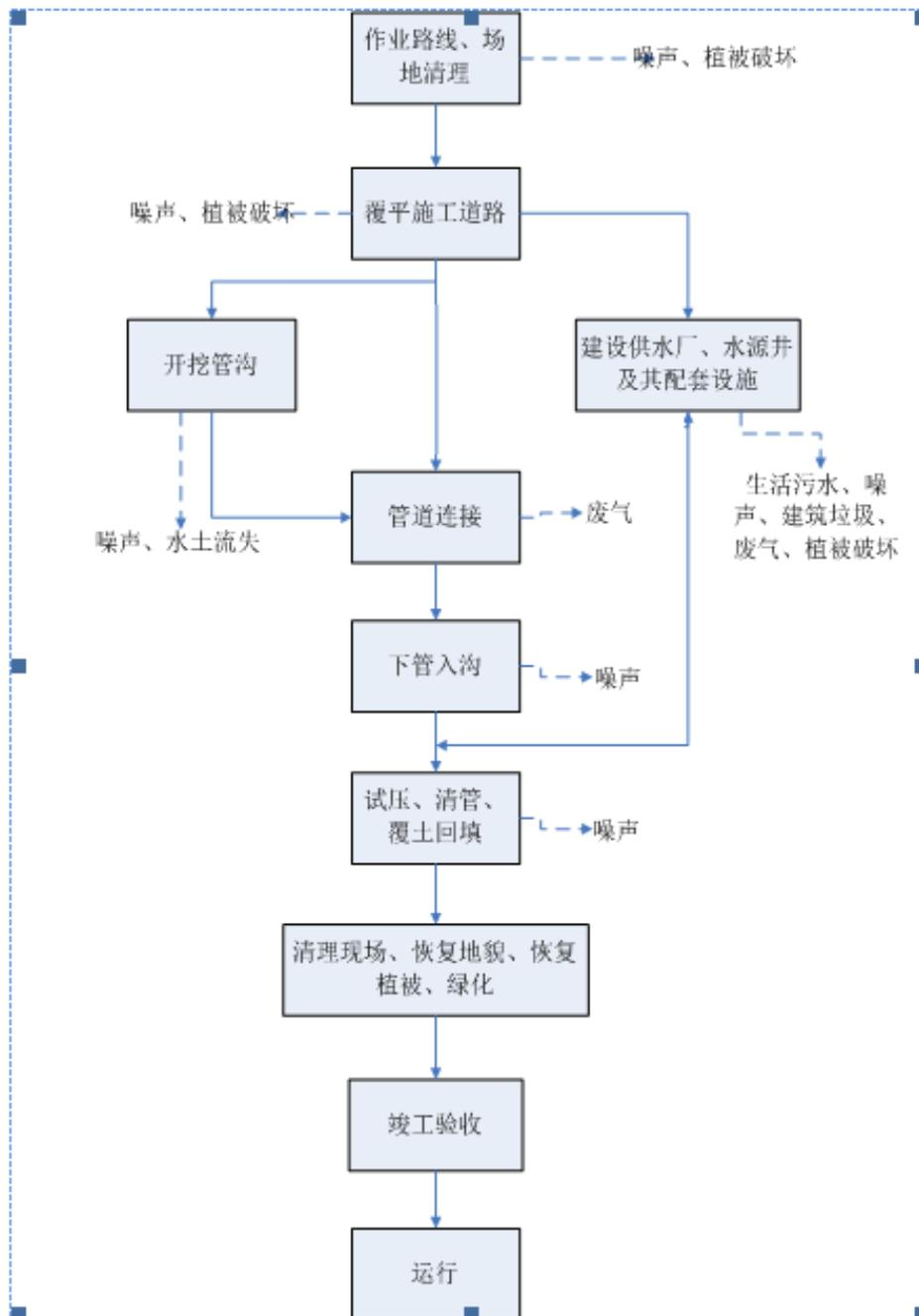
图 3 项目施工期工艺流程及产排污环节图
