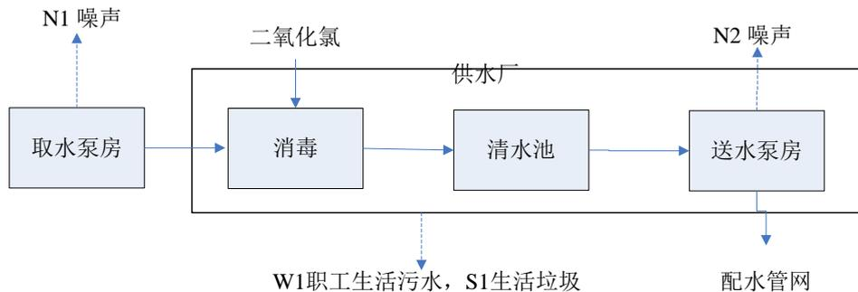
图5 项目运营期工艺流程及产排污环节图
