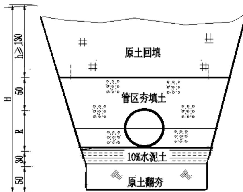
图 4 输水管道典型横剖面示意图
