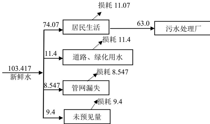
图9 日水平衡图（单位： $m^3/d$ ）
