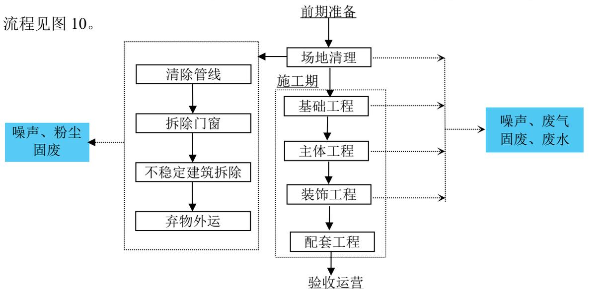
图 10 施工过程及产污节点示意图
