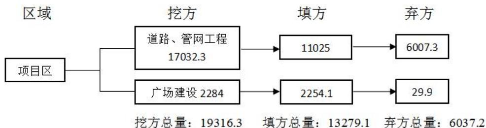
图 12 土石方平衡图
