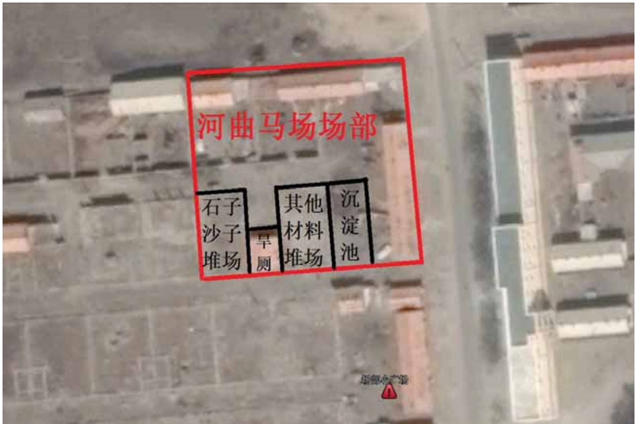
图 1-2 项目施工平面布置图
