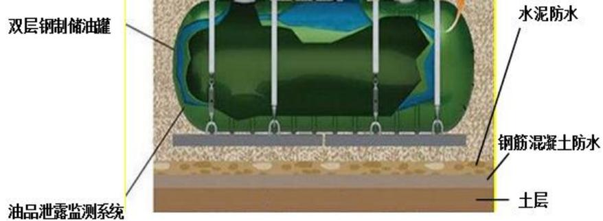
图 12 储油罐防渗结构图
