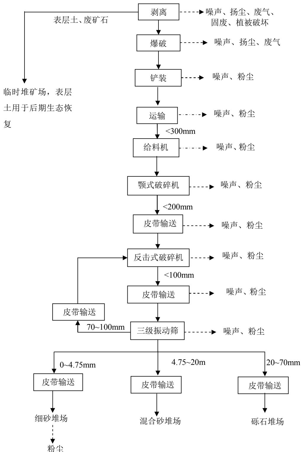
图 2.4-1 工艺流程及产污环节图
