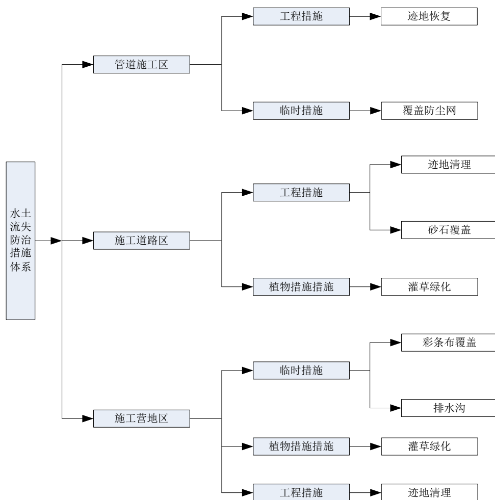
图12 项目水土流失防治工程体系框图
