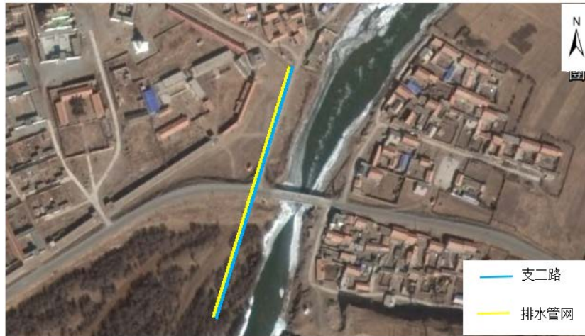
图 3.3 支二路段雨水管网布设图
