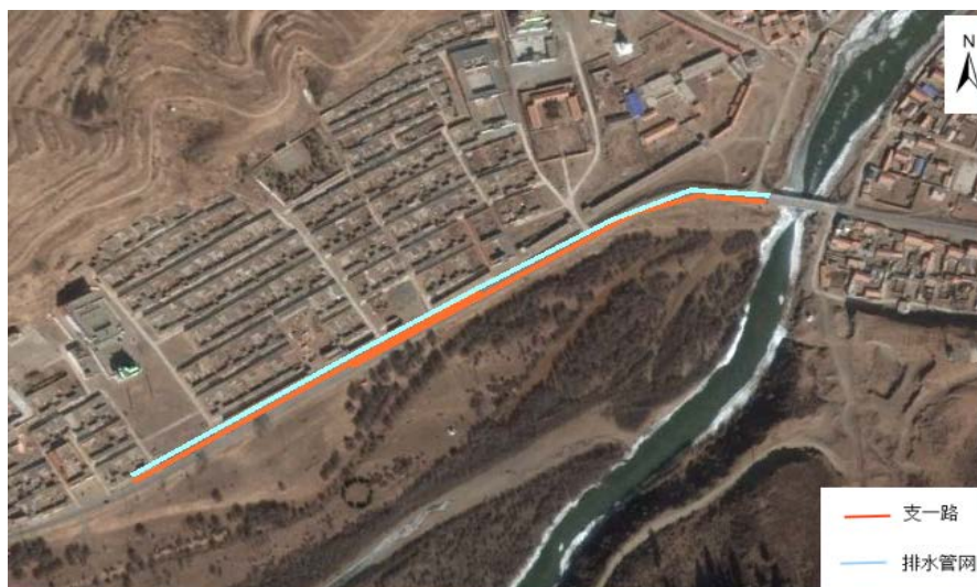
图 3.2 支一路段雨水管网布设图
