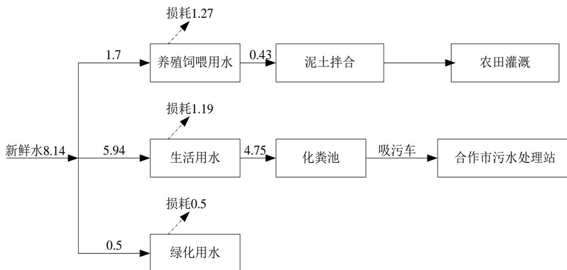
**图 8 项目给、排水平衡图 单位：m<sup>3</sup>/d**
