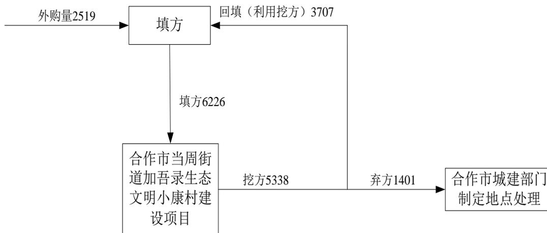
图 12 项目土石方流向图 单位: m<sup>3</sup>
